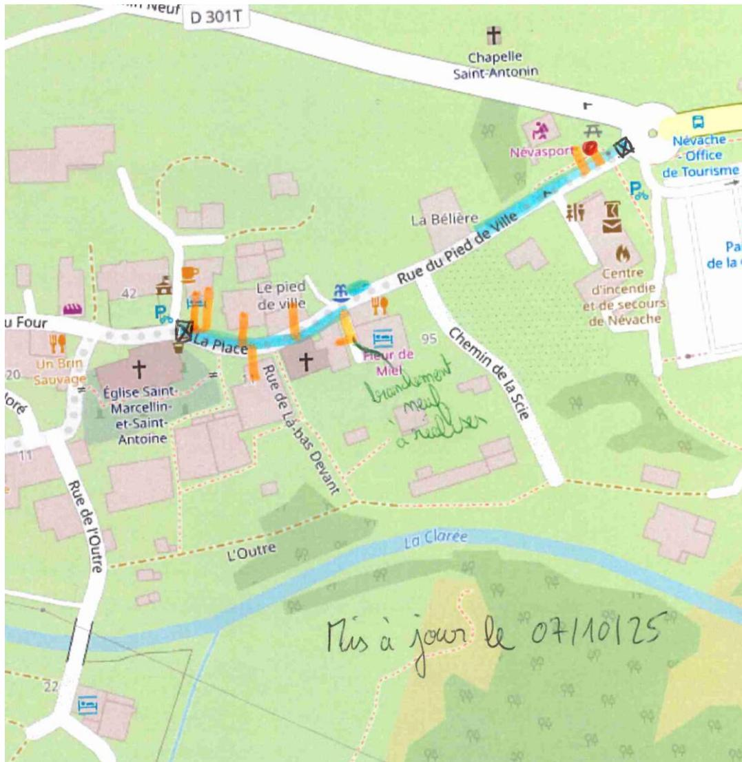
Avancement des travaux : en bleu la canalisation principale, en orange les branchements renouvelés.
